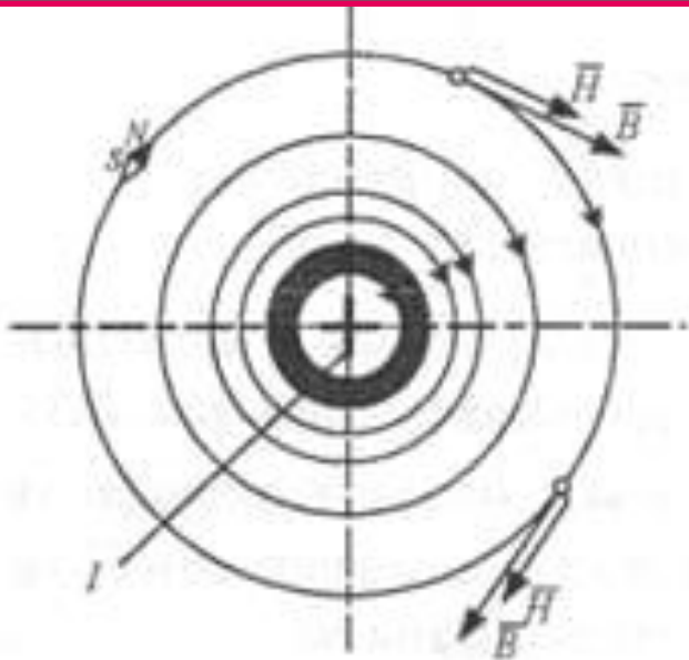
Магнітне поле струму прямолінійного круглого провідника
